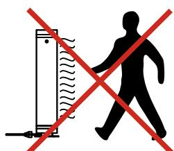
Nach der Inbetriebnahme der UV-C STERILON FLOW Lampe (nur bei direkter Desinfektion), **darf sich niemand in dem Raum, in dem die Leuchte betrieben wird, aufhalten.**
